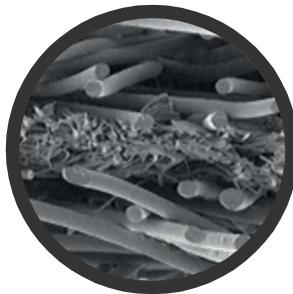
Beim Hydrocharging-Verfahren wird in hochtechnisierten Anlagen deionisiertes Wasser auf die Fasern aufgebracht. Die positiven und negativen Ladungen koexistieren und weisen die Eigenschaft einer elektrischen Doppelschicht im Gewebe auf. Dadurch müssen nur halb so viele Gewebefasern verwendet werden wie üblich. Das Hydrocharging-Verfahren erhöht die Filterleistung bei gleichbleibend niedrigem Atemwiderstand.
